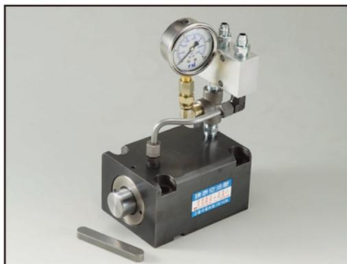
壓力計裝在引導式逆止閥上，可測出油壓缸是否內漏及油壓力量是否足夠。
